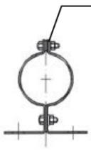
Dispositivo di fissaggio
