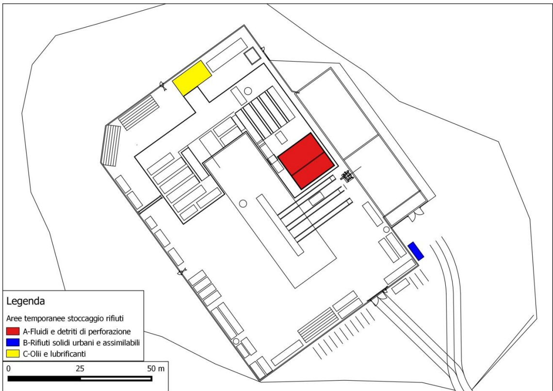
Figura 1-2. Ubicazione delle aree di stoccaggio temporaneo dei rifiuti nel postazione di perforazione Lucignano 2.
