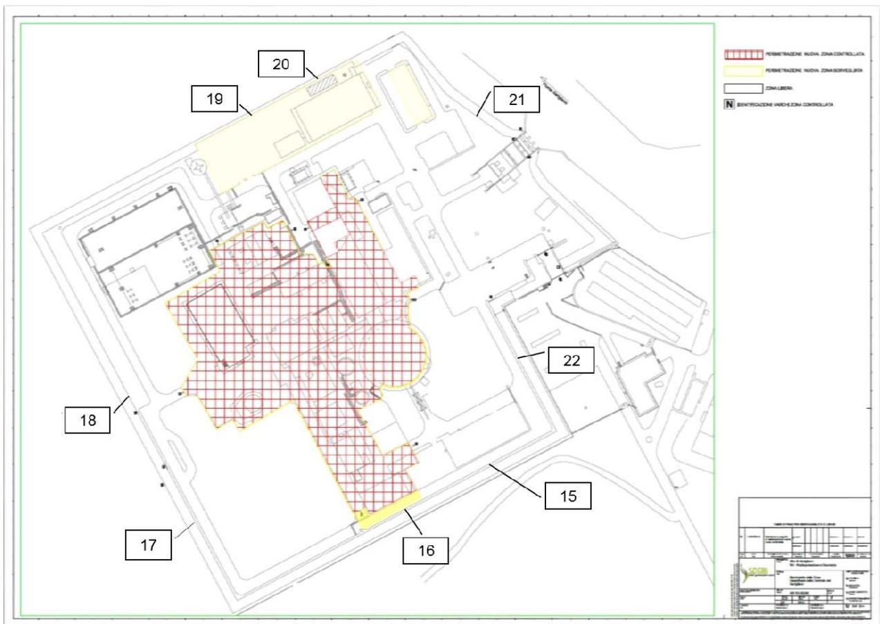
Figura 1 - Ubicazione dei dosimetri lungo la recinzione dell'Impianto
