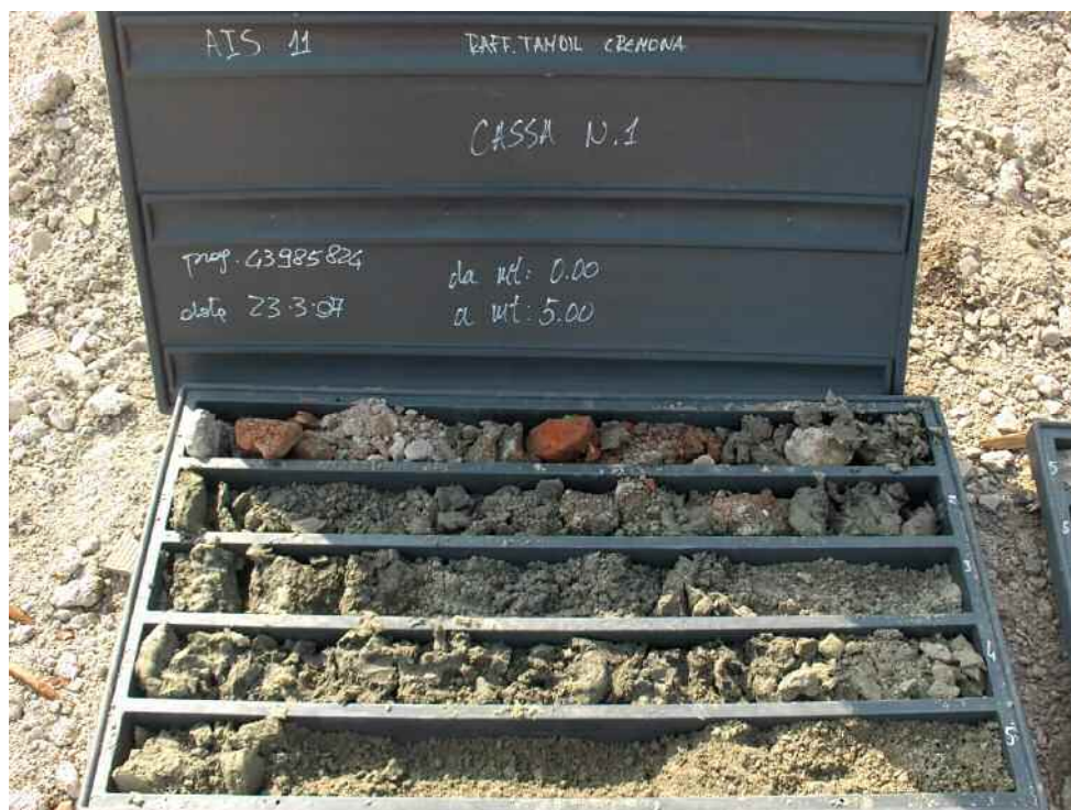
Sondaggio AIS11 (0-5 m da p.c.)
