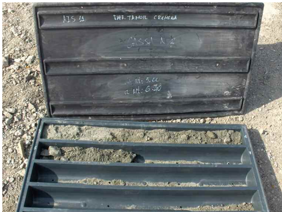
Sondaggio AIS11 (5-6,5 m da p.c.)
