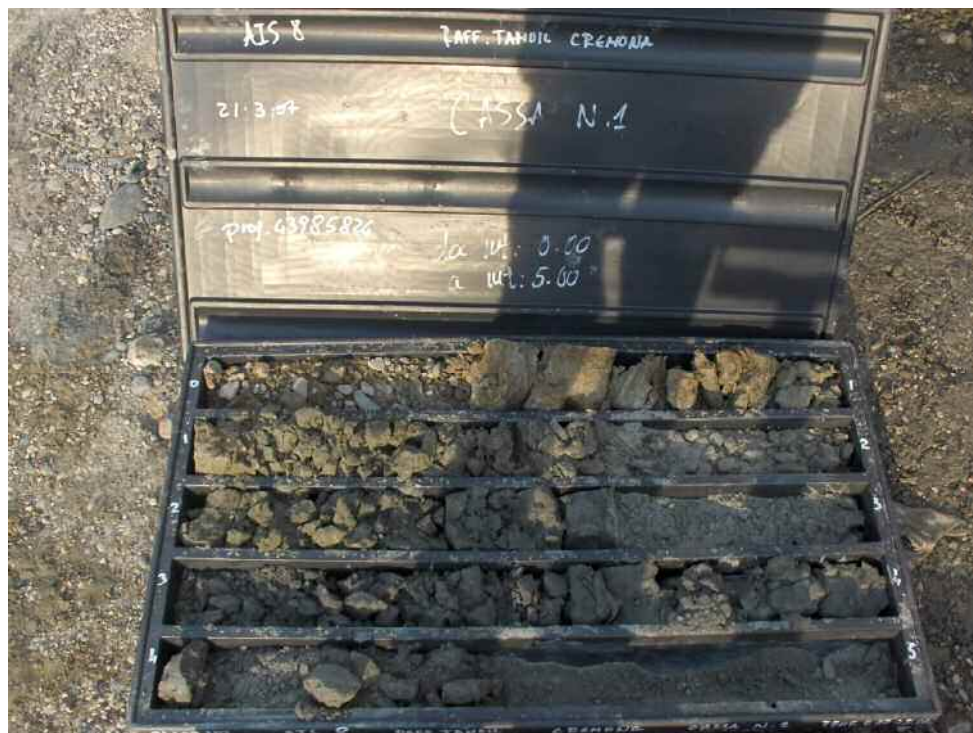
Sondaggio AIS8 (0-5 m da p.c.)
