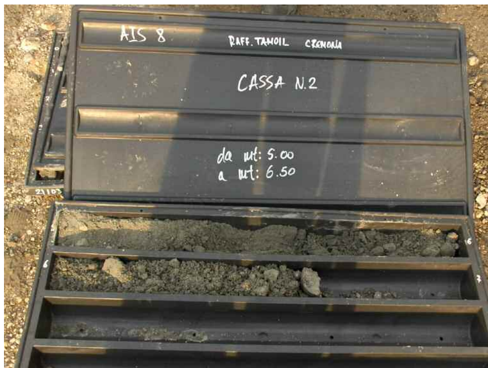
Sondaggio AIS8 (5-6,5 m da p.c.)
