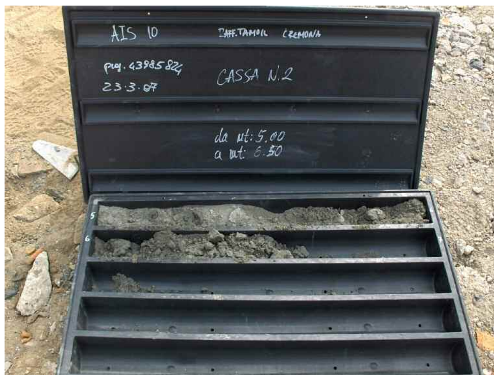
Sondaggio AIS10 (5-6,5 m da p.c.)
