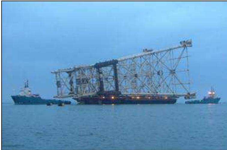
**Figura 3-7: Alcune immagini relative al trasporto delle strutture rimosse**
