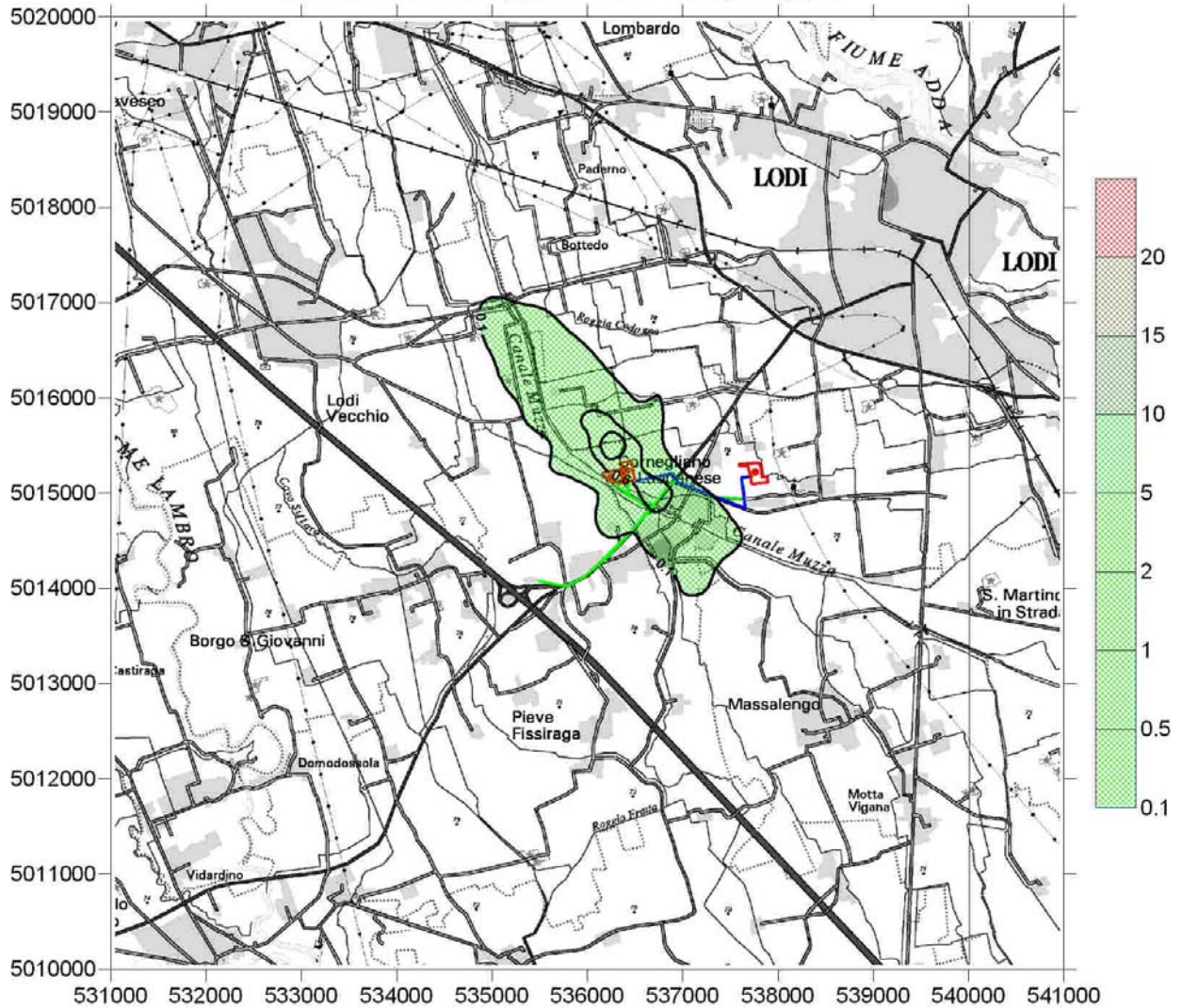
Figura 32 –Concentrazioni media annuale di PM 10 durante le attività di cantiere del Cluster A
