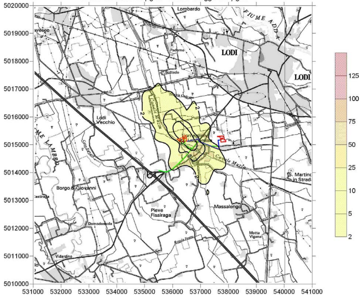
Figura 5 – Concentrazione media giornaliera di SO_2 superata per 3 giorni/anno durante le attività di cantiere del Cluster A
