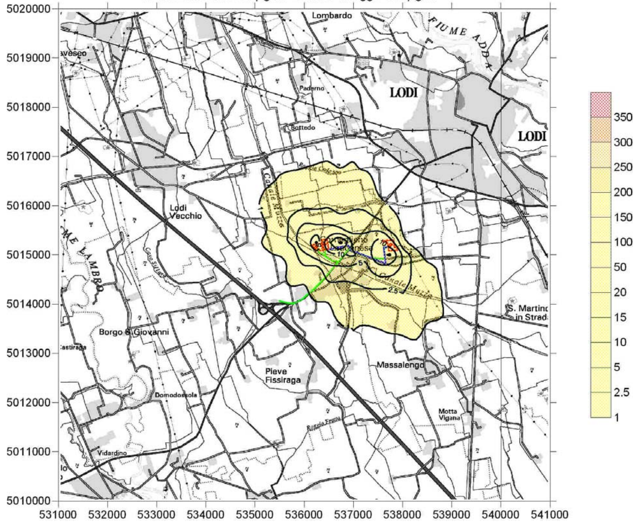
Figura 11 – Concentrazione media oraria di SO_2 superata per 24 ore/anno durante le attività di cantiere nell'area di Centrale e lungo la linea del metanodotto
