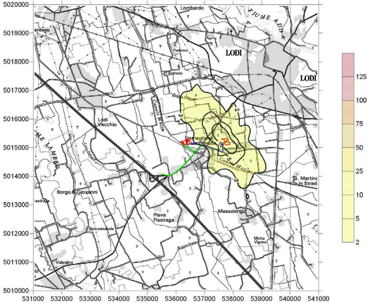
Figura 6 – Concentrazione media giornaliera di SO 2 superata per 3 giorni/anno durante le attività di cantiere del Cluster B
