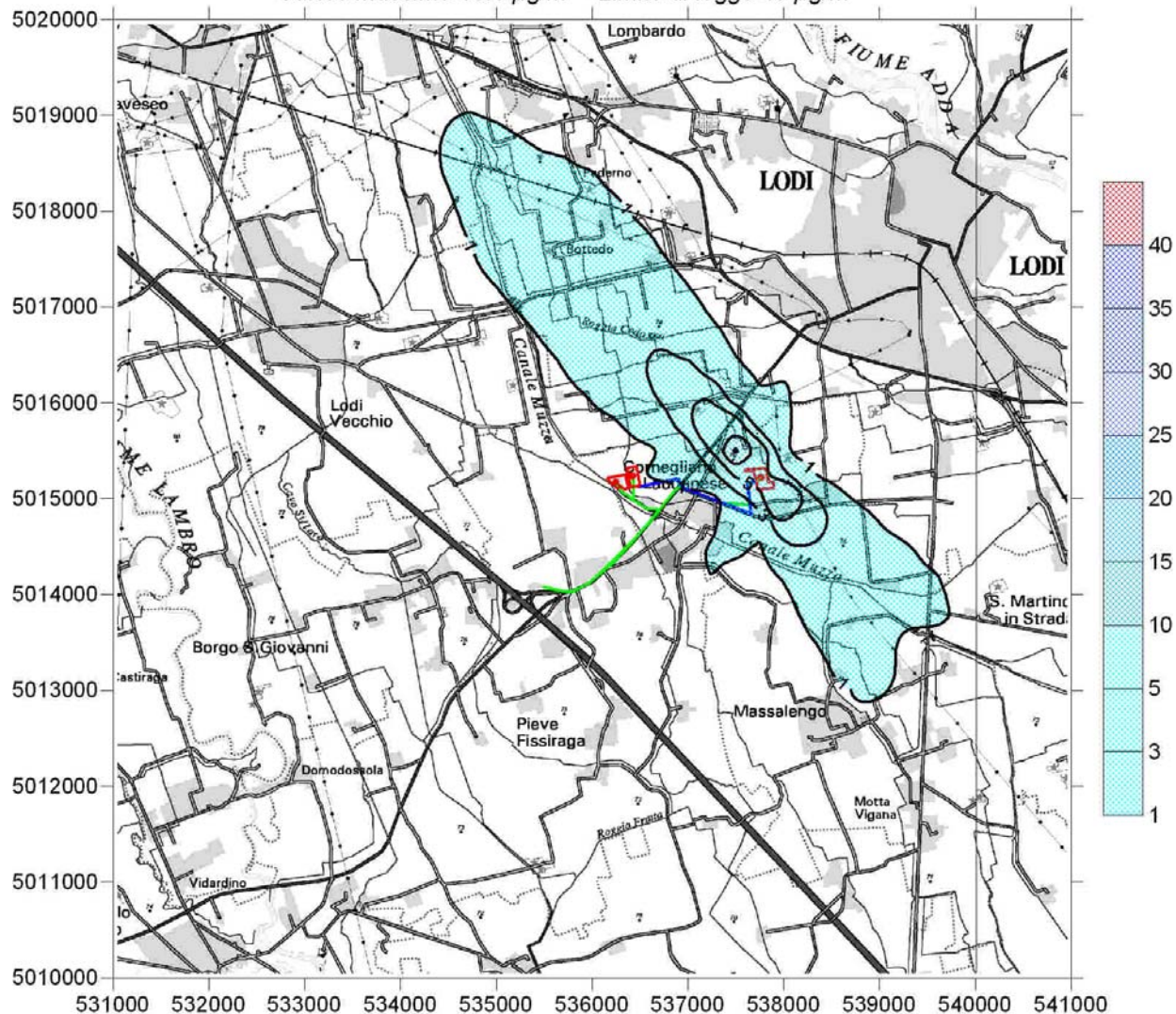
Figura 15 – Concentrazioni media annuale di NO 2 durante le attività di cantiere del Cluster B
