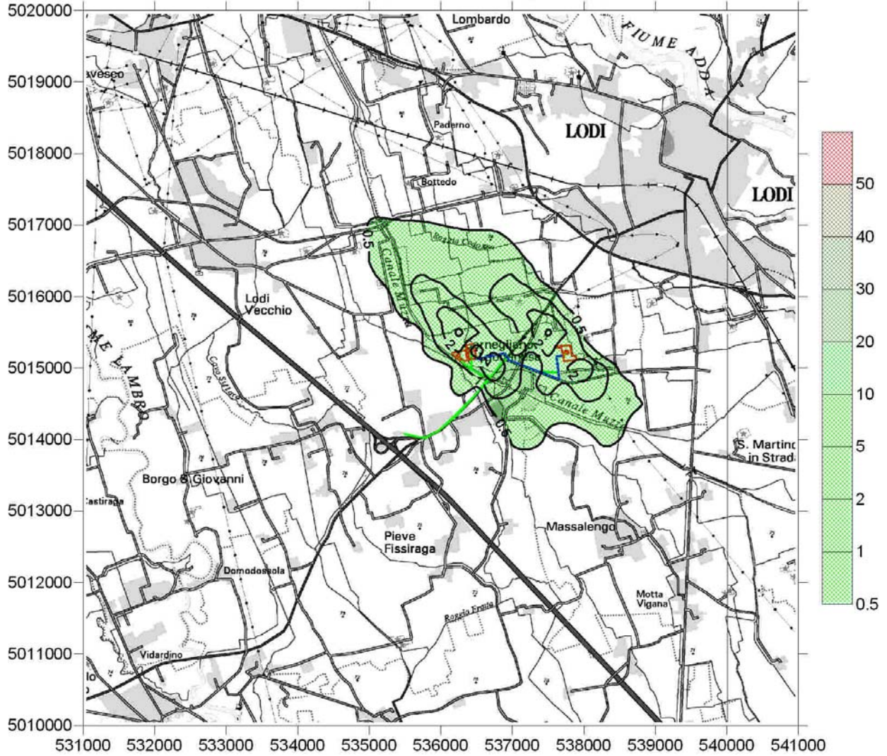
Figura 39 – Concentrazioni media giornaliera di PM 10 superata per 35 giorni/anno durante le attività di cantiere dei Cluster A e B, nell’area di Centrale e lungo la linea del metanodotto
