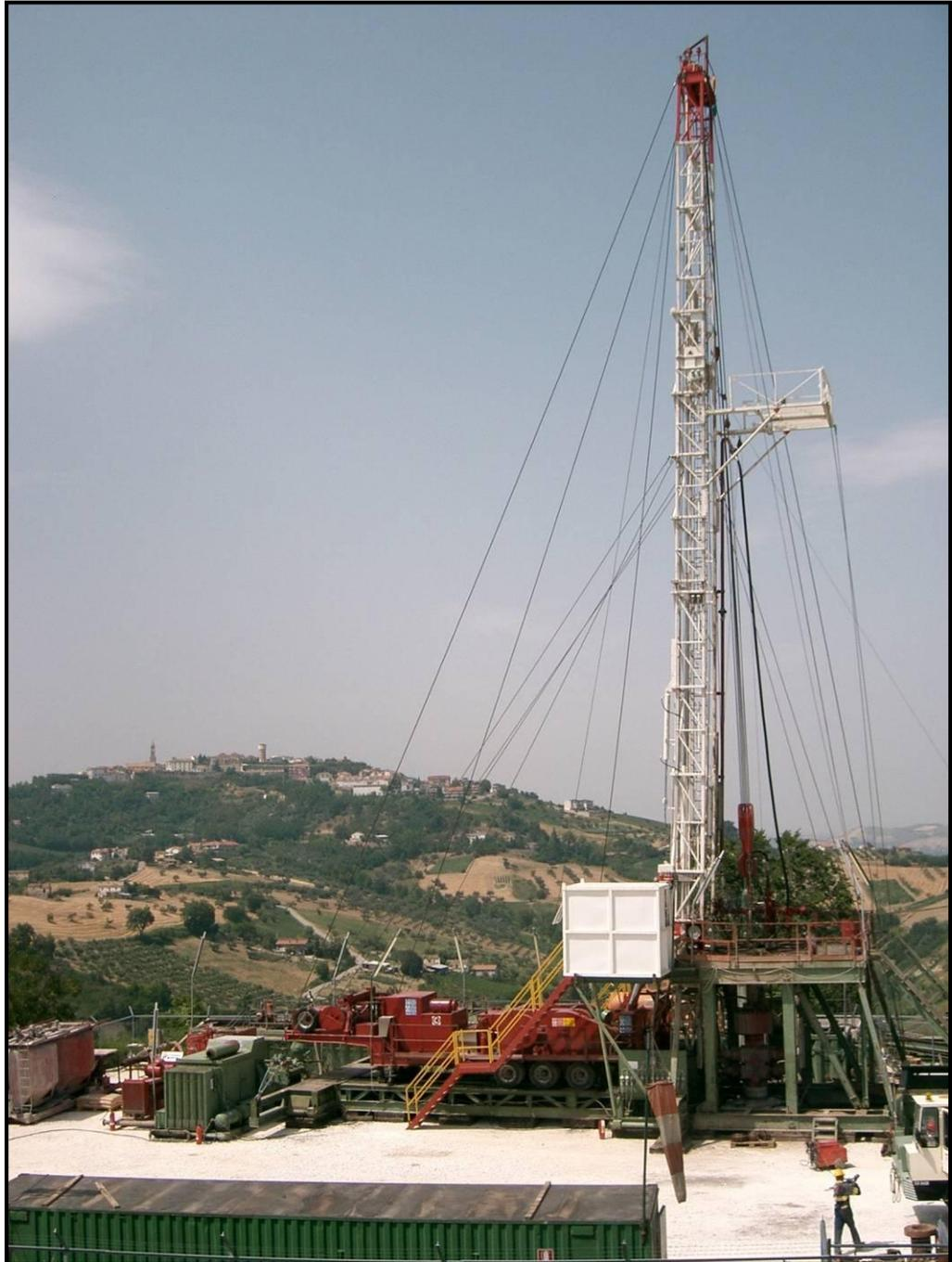
In Figura 3.3.3.3b si riporta, a titolo di esempio, la foto di un tipo di impianto moderno, molto compatto, idoneo a raggiungere agevolmente la profondità massima dei pozzi reiniettivi. Si tratta di un impianto ad azionamento idraulico dei componenti.
