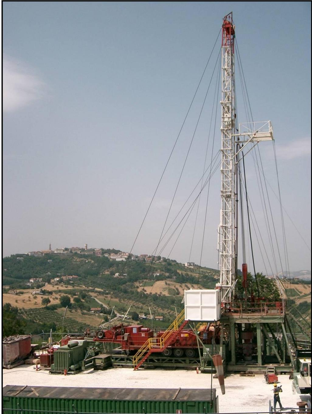
In Figura 3.2c si riporta, a titolo di esempio, la foto di un tipo di impianto moderno, molto compatto, idoneo a raggiungere agevolmente la profondità massima dei pozzi reiniettivi. Si tratta di un impianto ad azionamento idraulico dei componenti.
