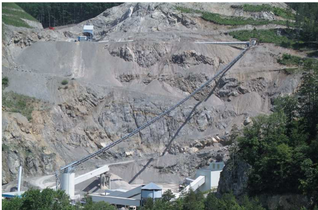
Figura 4-7 Esempio di nastro sospeso – tipologia utilizzata nel P.E. II Fase.
