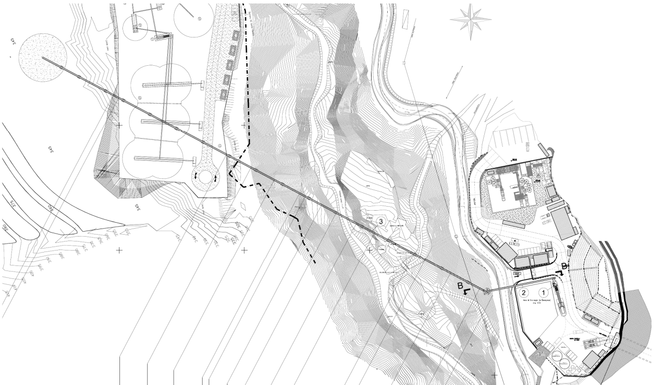
Figura 4-1 Tracciato del nastro trasportatore nel layout del PD.
