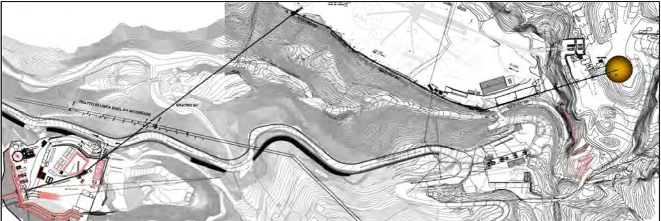
**Figura 5.2 – Sistema di trasporto a nastro dello smarino da CLS2 a Cava Castellaro**
