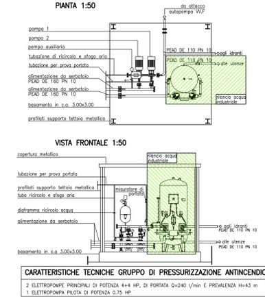
STAZIONE DI PRESSURIZZAZIONE ANTINCENDIO: SCHEMA IDRAULICO
