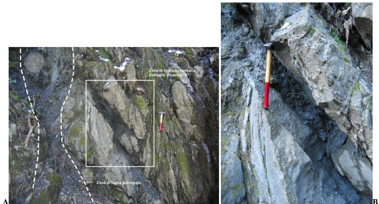
Figura 7 - Faglia all'interno degli argilloscisti nei dintorni di Case Noage (progressiva della Galleria di Valico 9+700 ca.). Si notino le superfici di movimento caratterizzate da gouge non coesivo.
