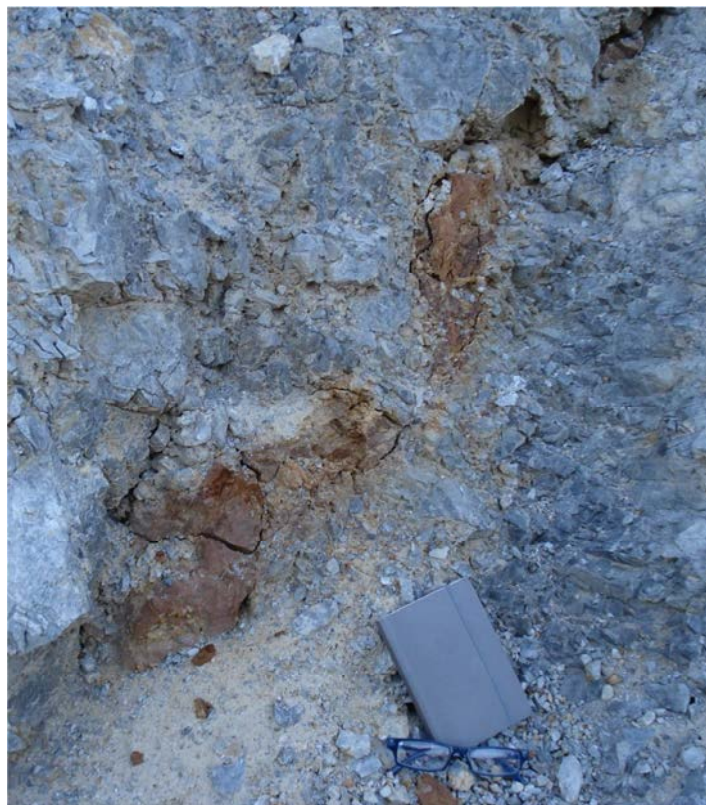
Cava di M. Carmelo, settore meridionale. Cavità lungo fratture riempite di argille rosse residuali. Dimensioni delle lenti argillose da centimetriche a decimetriche
