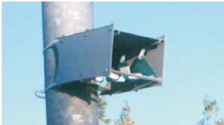
Figura 3-64: esempio di posizionamento di campionatori passivi all'interno di box protettivo
