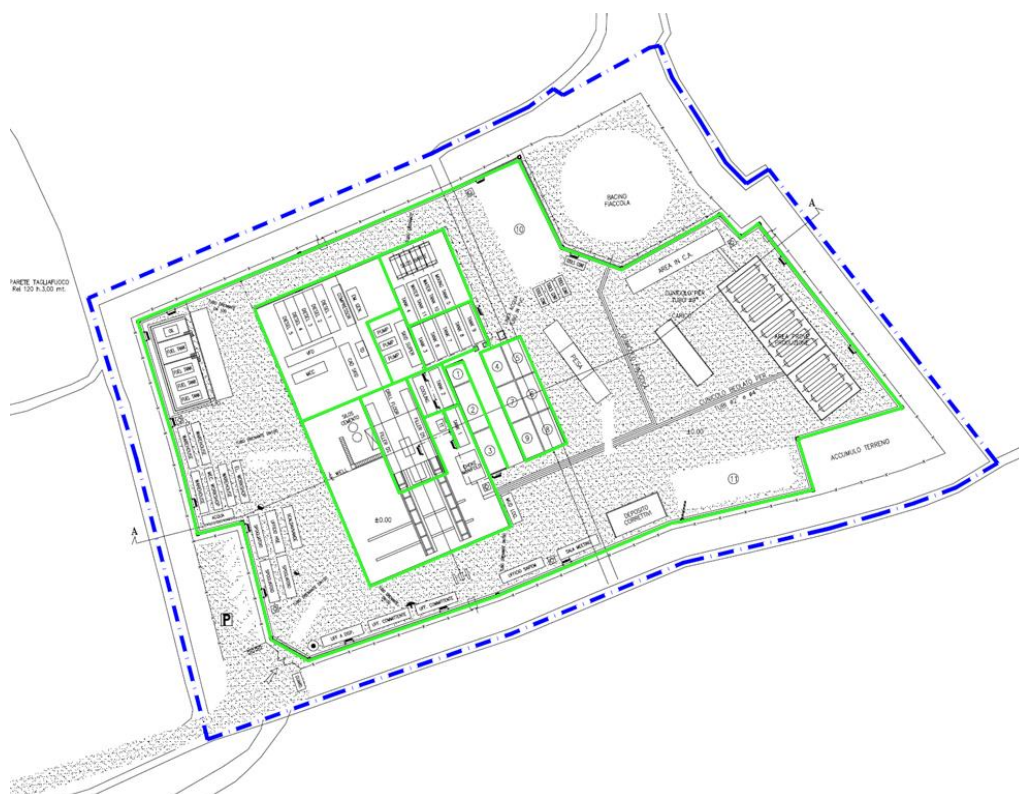
Figura 3-15: Individuazione delle aree interne alla postazione caratterizzate dalla presenza di telo impermeabile
