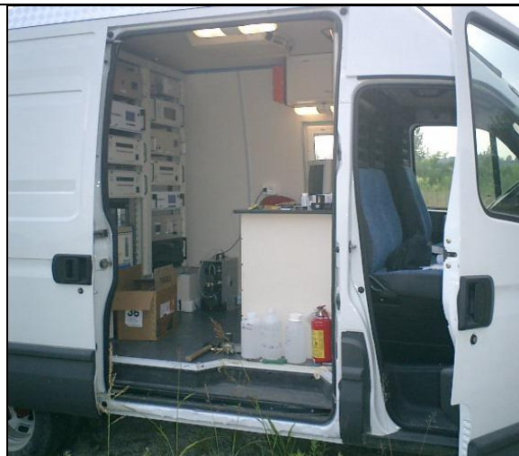
Figura 3-62: esempio di laboratorio mobile per il monitoraggio della qualità dell'aria ambiente
