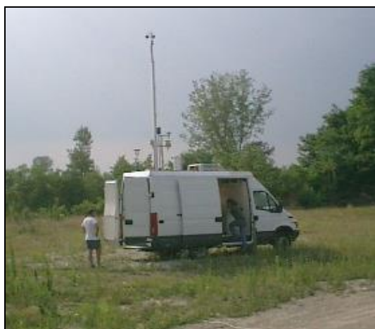
Figura 3-62: esempio di laboratorio mobile per il monitoraggio della qualità dell'aria ambiente
