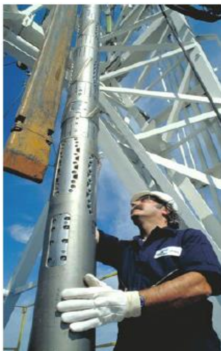
Figura 3-7: Sonda (log) su testa pozzo pronta a scendere. Il materiale radiogeno, in cilindro di acciaio sigillato, e' inserito all'interno della sonda in apposito compartimento
