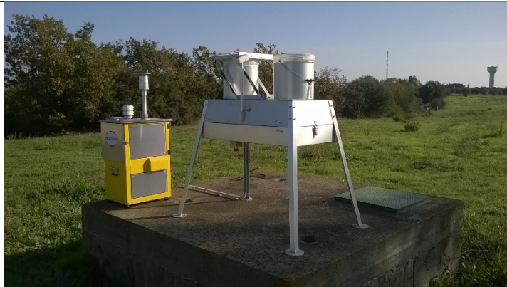
Campionatore sequenziale e deposimetro
