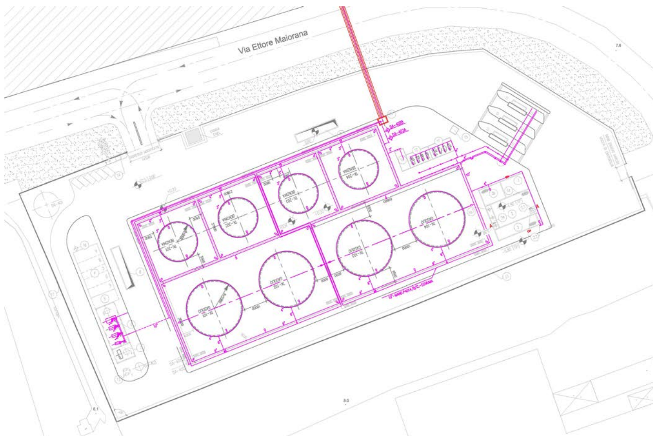
FIGURA 3 - LAYOUT TUBAZIONI CIRCUITO SCHIUMA
