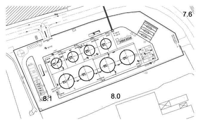
La configurazione planimetrica del deposito è dettata dal Titolo IV del D.M. 31/07/34, per il quale, secondo i criteri di protezione incendio, devono essere rispettate le seguenti distanze per le diverse categorie di liquidi:
