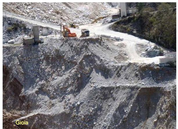
**Fig. 11.** I ravaneti recenti, contenenti grandi quantità di terre, sono impermeabili e suscettibili a frane: vanno perciò rimossi.
