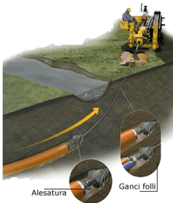
Figura 7 – Schema tipo di utilizzo tecnologia No Dig fase di infilaggio tubo entro foro
