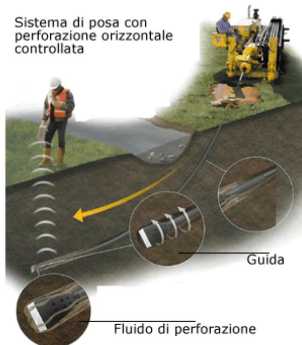
Figura 6 – Schema tipo di utilizzo tecnologia No Dig fase di realizzazione foro teleguidato
