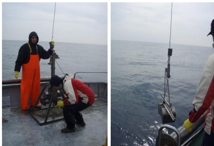
Fig. 2.3 – Box-corer utilizzato per le indagini fisiche e chimiche dei sedimenti (a sinistra) e calo della benna Van Veen utilizzata per lo studio della comunità bentonica (a destra).
