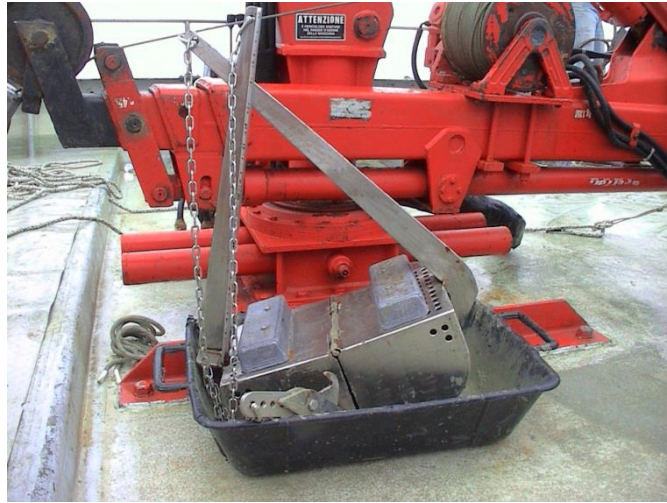
Fig. 2.7 – Benna Van-Veen utilizzata per le indagini sulla comunità bentonica.
