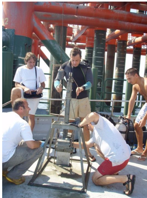
Fig. 2.6 – Box-corer utilizzato per le indagini fisiche e chimiche dei sedimenti.
