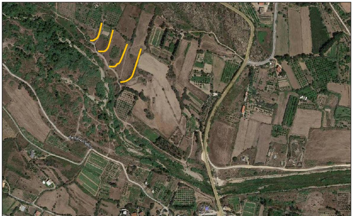
Figura 6.2 – Pennelli a protezione delle aree agricole in sponda sinistra a monte ponte SS 125.
