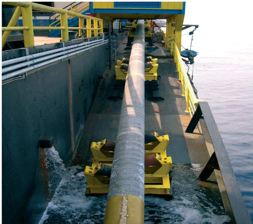
**Fig. 5.3 - Particolare della Rampa di Varo di un Tipico Mezzo Posatubi**
