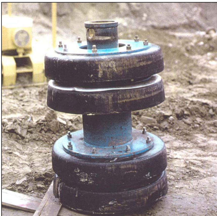
Fig. 6.2/A: Pig convenzionale impiegato nelle operazioni di collaudo idraulico e di pulizia della condotta.
