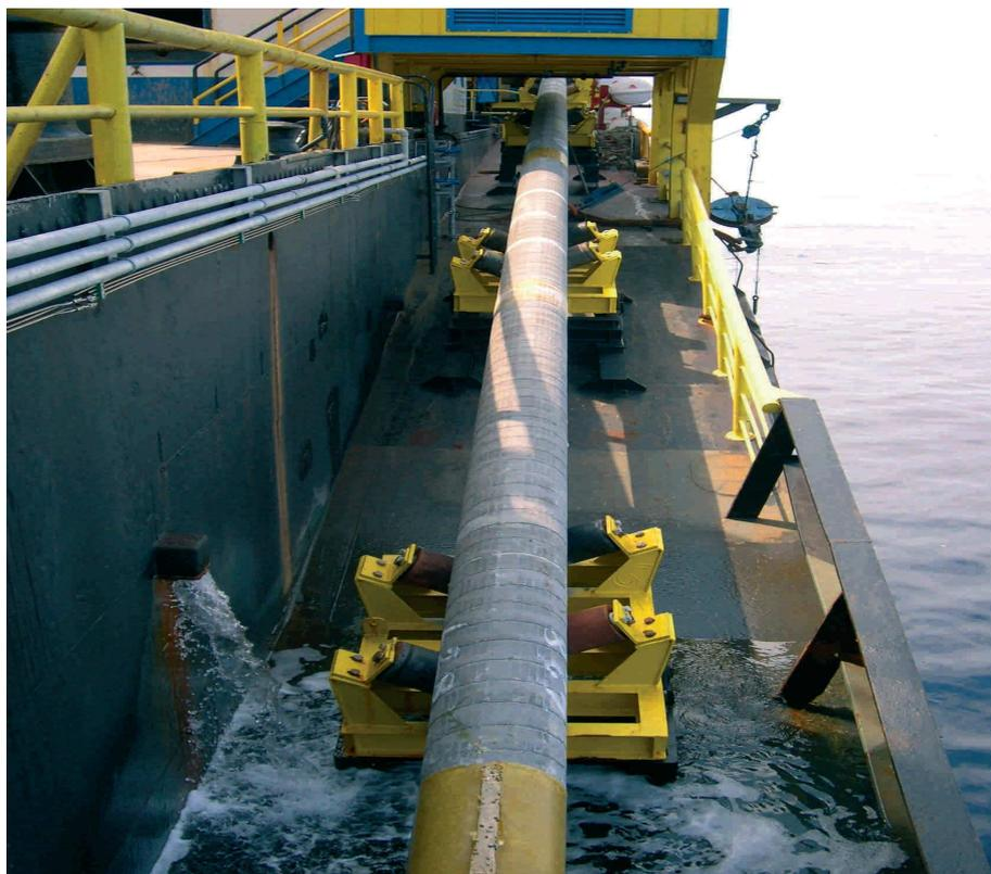
**Fig. 5.1** - Particolare della Rampa di Varo di un Tipico Mezzo Posatubi
