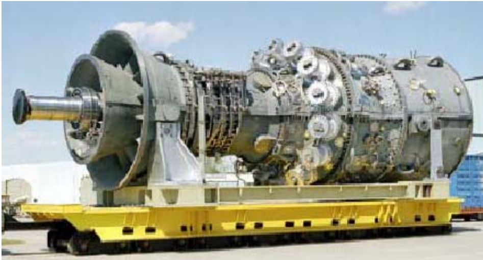
Fig. 3.10 Turbina a gas della serie H
