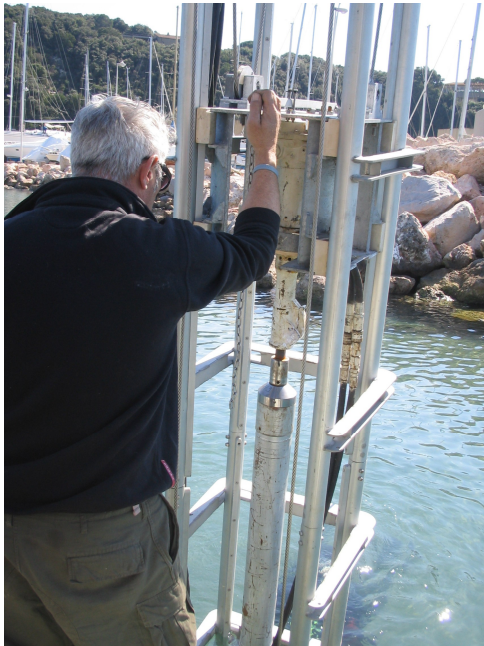
Foto 1.2 – Operazioni di campionamento con il carotiere.
