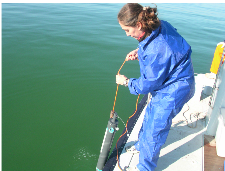
Foto 1.2 - Campionamento acqua con la bottiglia Niskin
