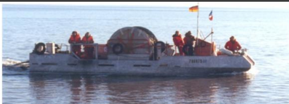
Imbarcazione Tipo Utilizzata per lo Stendimento dei Geofoni al Fondo
