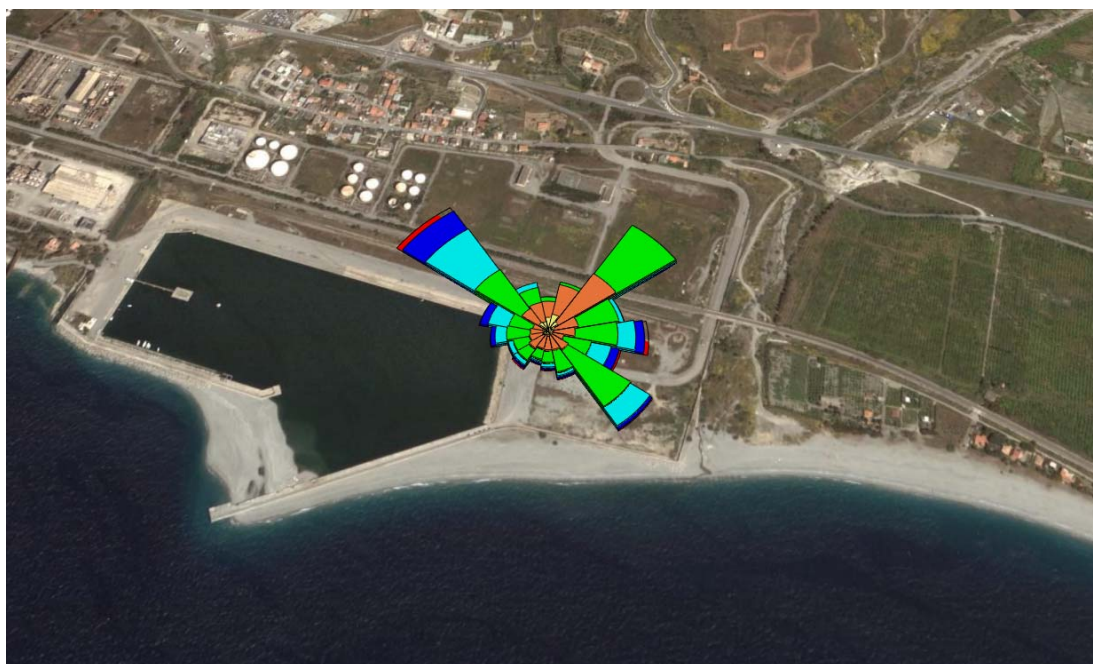
Figura 4.9 Rosa dei venti al suolo sovrapposta all'immagine satellitare del sito (ottenuta a partire dalle misure della centralina meteorologica di Saline Joniche relative all'anno 2004)
