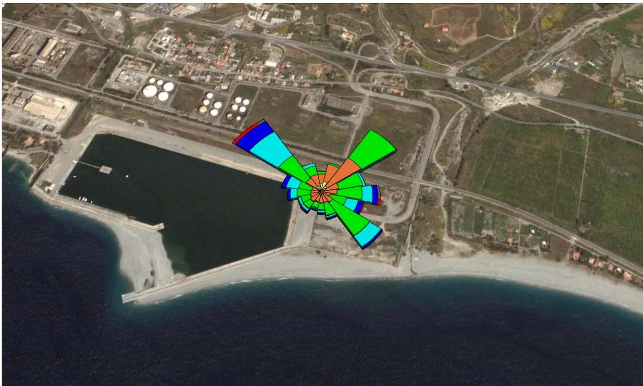
Figura 7. Rosa dei venti sovrapposta all'immagine satellitare del sito (ottenuta a partire dalle misure della centralina meteorologica di Saline Ioniche relative all'anno 2004). Tilting di 30 gradi rispetto alla verticale.
