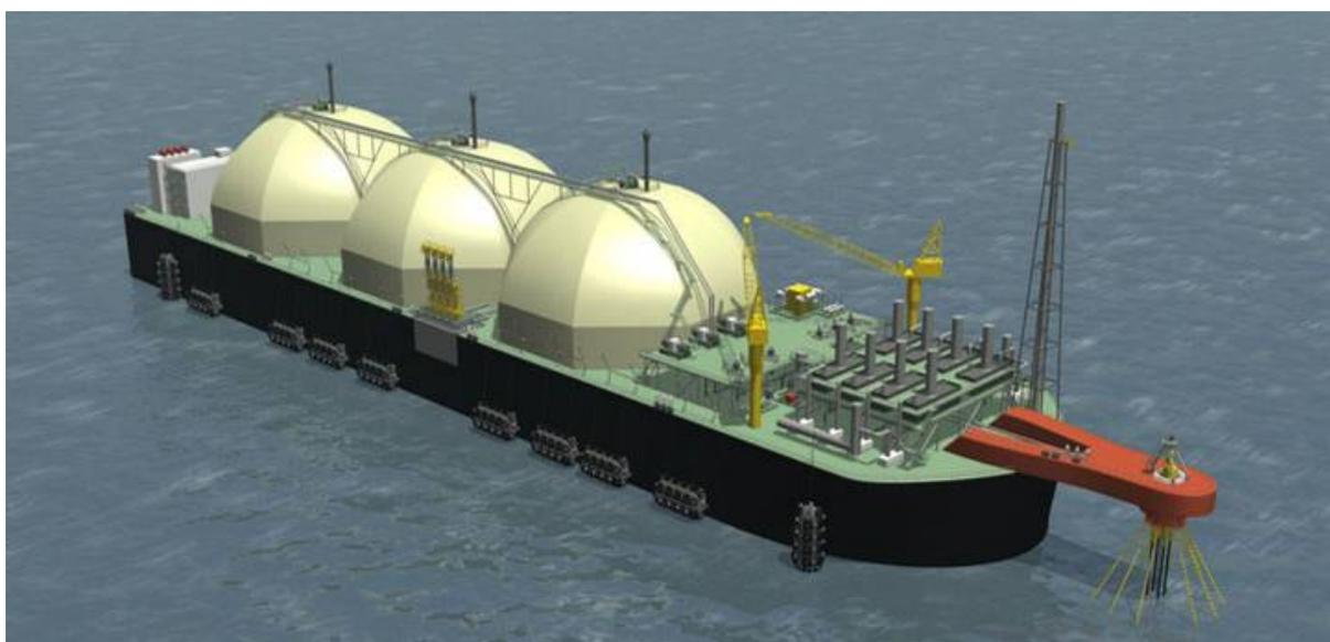
**Figura 4.4/2 - FSRU ancorata a torretta di scarico (tipo SPM)**
