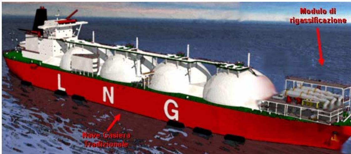
Figura 1-6 : vista pittorica di una nave rigassificatrice
