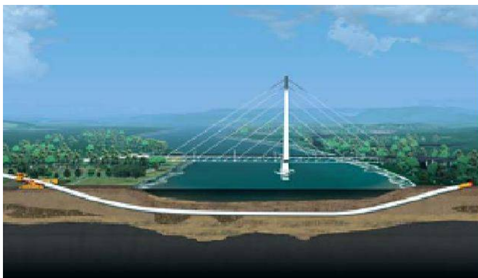
Figura 2.6.3/9 - Schema di installazione con tecnologia “Direct Pipe”
