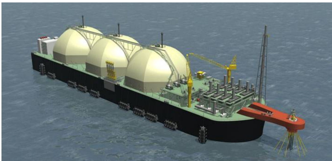
Figura 2.1.4/2 - FSRU ancorata a torretta di scarico (tipo SPM)
