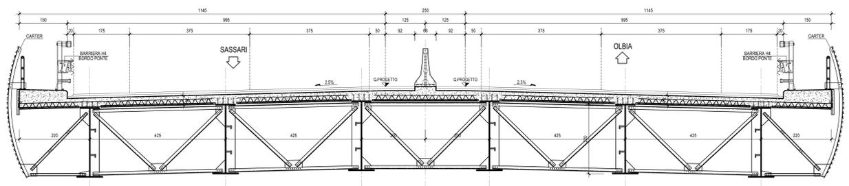
**SEZIONE TRASVERSALE TIPO IN ASSE APPOGGI-Scala 1:50**
