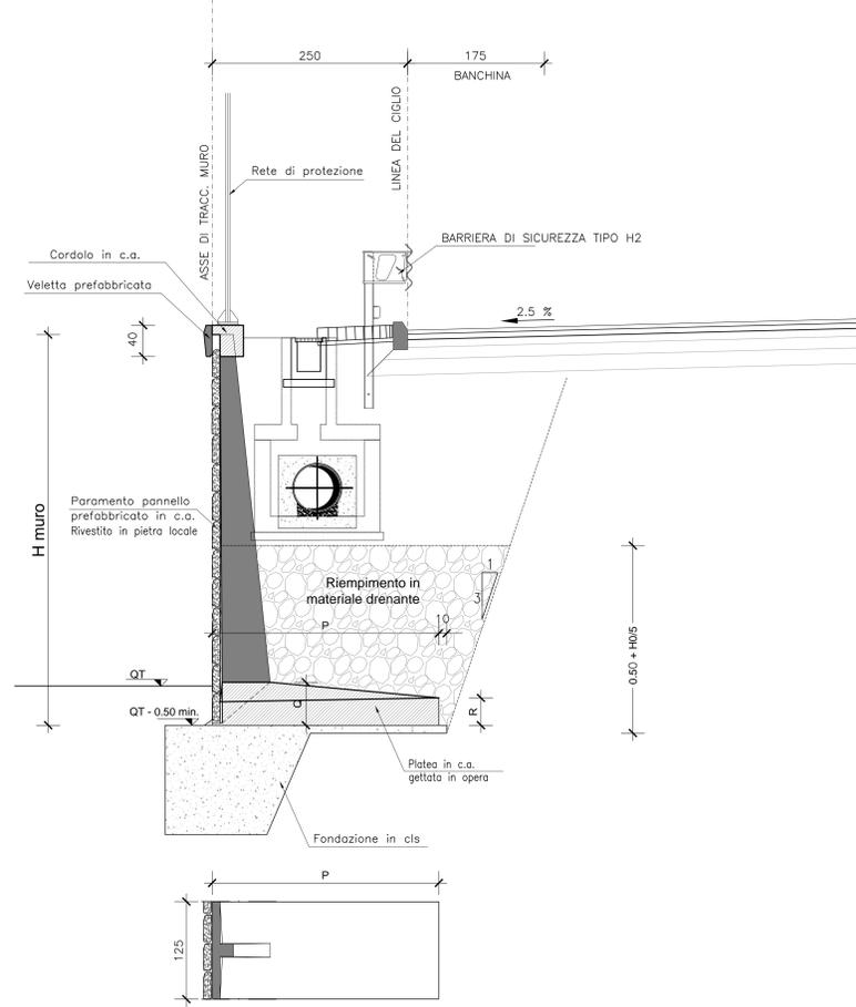
SEZIONE TIPO MURO DI CONTRORIPA Scala 1:50
