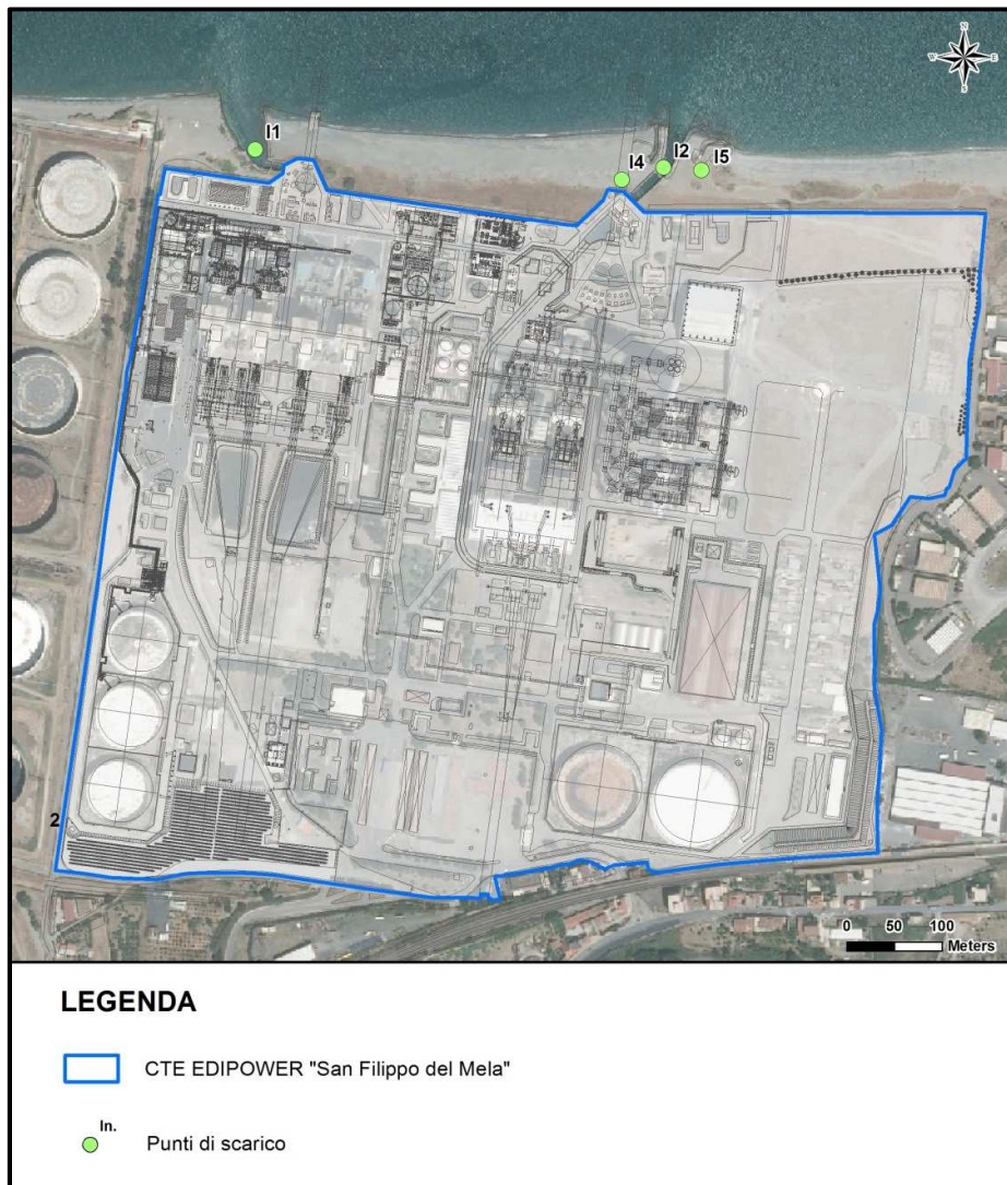
Figura 3.2.7.4a Localizzazione punti di scarico autorizzati AIA della CTE
