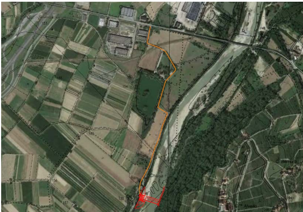
Fig. 12.1 Individuazione (in arancio) del percorso di accesso all'area di intervento che prevede l'utilizzo della viabilità esistente, senza la realizzazione di nuove piste di accesso.
