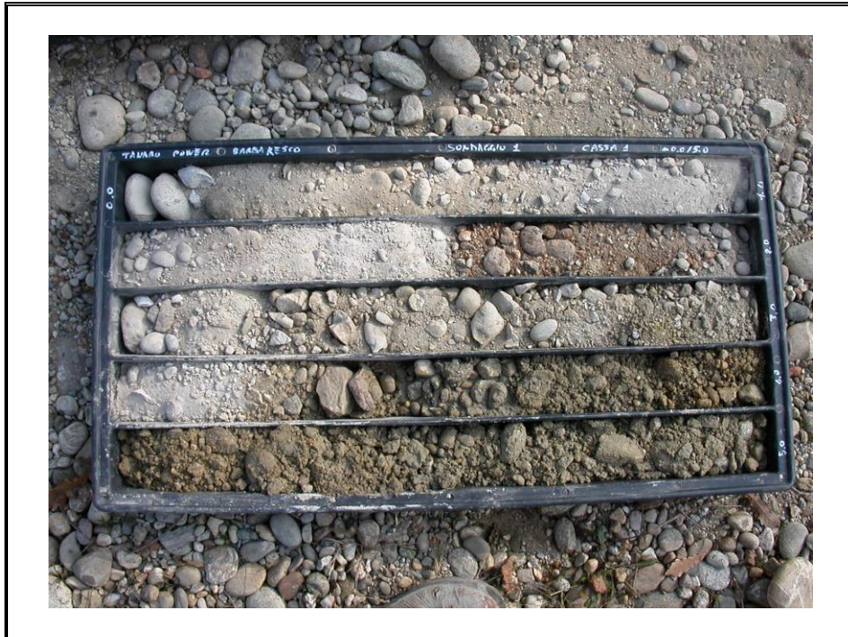
Foto 1: Sondaggio S1 - cassa 1 - da 0.00 m a 5.00 m.
