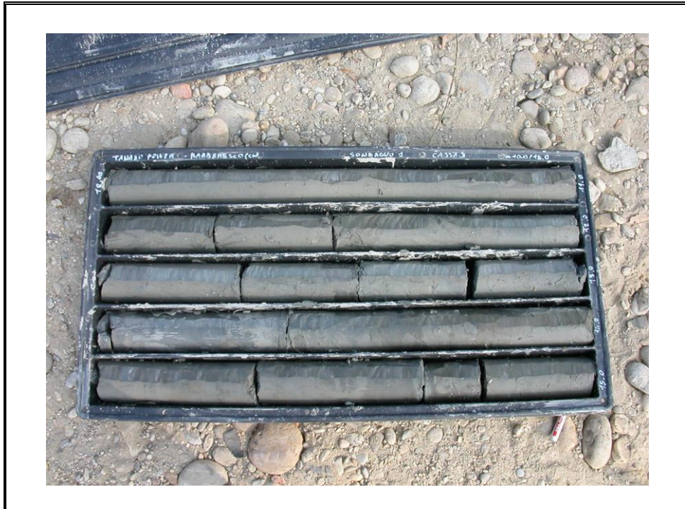
Foto 3: Sondaggio S1 - cassa 3 - da 10.00 m a 15.00 m.
