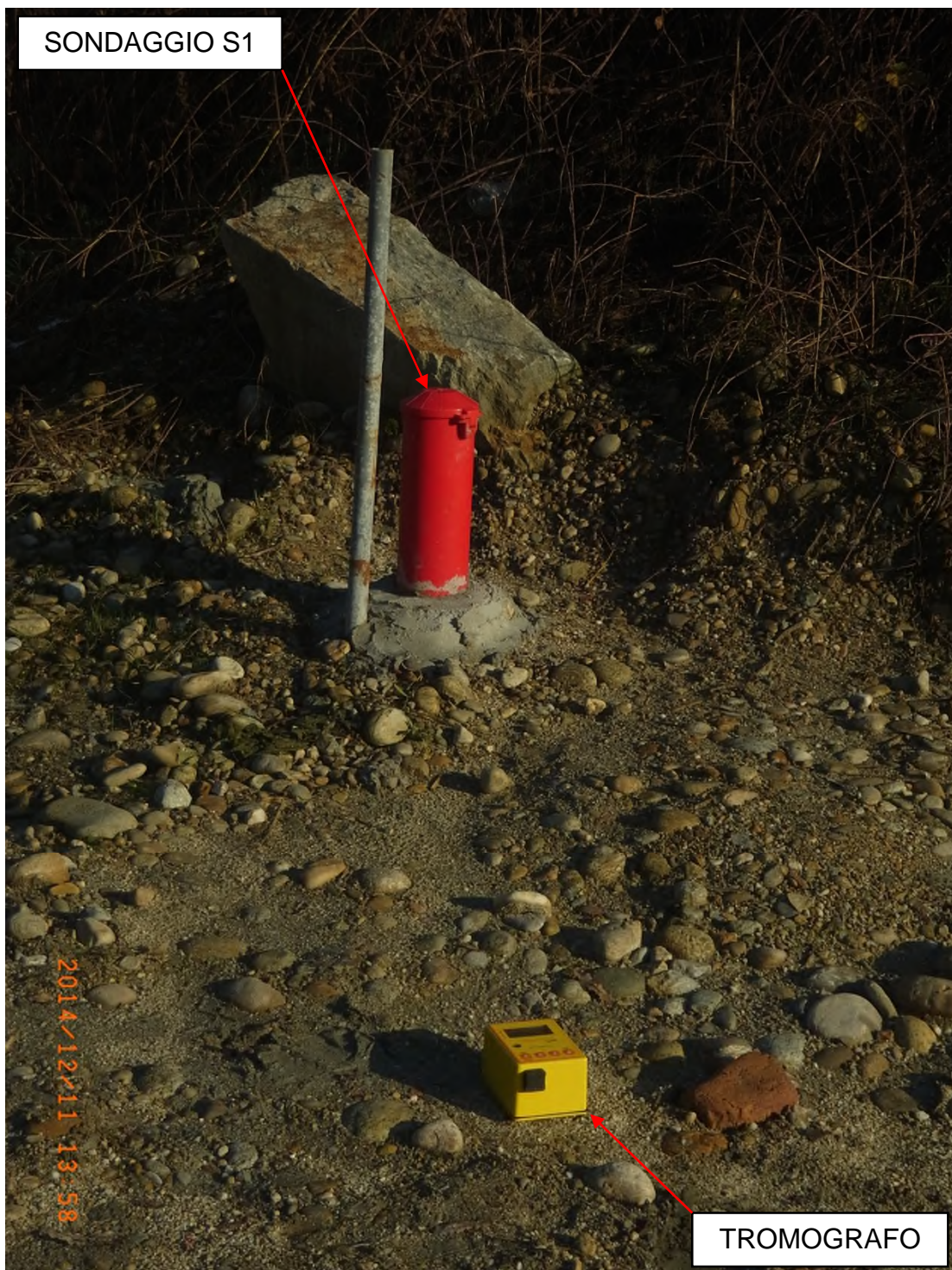
Fig. 3.4 - Particolare e ubicazione dello strumento utilizzato (Tromografo TROMINO).
