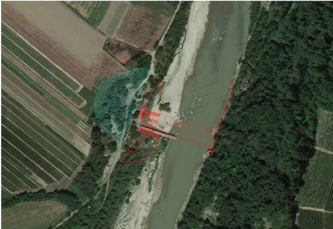
Figura 1.5 – Estratto da Elaborato A1.1 “Relazione tecnica particolareggiata” allegata al progetto “Ricostruzione di sbarramento fluviale esistente ad uso irriguo con innalzamento abbattibile ad uso idroelettrico e centrale in corpo traversa”. L’area destinata a recupero morfologico (lunata in sponda sinistra) è indicata mediante un tratteggio ciano
