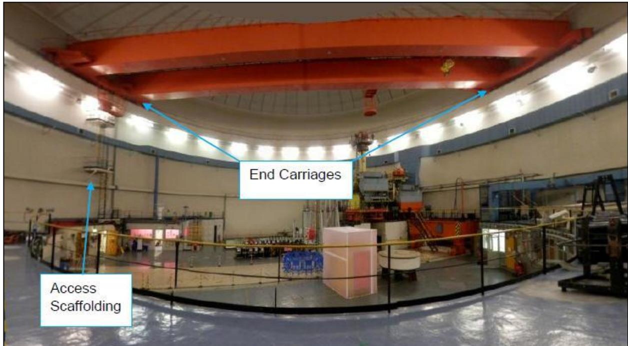
**Figura 5-15: Vista d'insieme del carro ponte circolare nell'Edificio 80**
