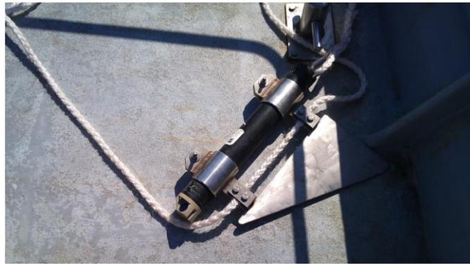
**Correntometro** Aquadopp (nell'immagine a destra montato su apposito supporto utilizzato per l'installazione sulla catena correntometrica).
