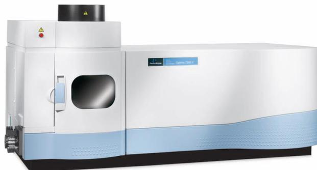
Spettrofotometro ad emissione atomica al plasma ad accoppiamento induttivo (ICP) e lettura sequenziale. Generatore multifrequenze nel range 750-1500 W Il sistema di raccolta della radiazione emessa dal plasma è di tipo assiale e radiale. Banda di analisi: 163-782 nm. Gas flusso principale e secondario: Argon gas ultrapuro (flusso 0-20 l/min). Gas stabilizzazione spettrofotometro: Azoto ultrapuro (flusso: 5 l/min).
