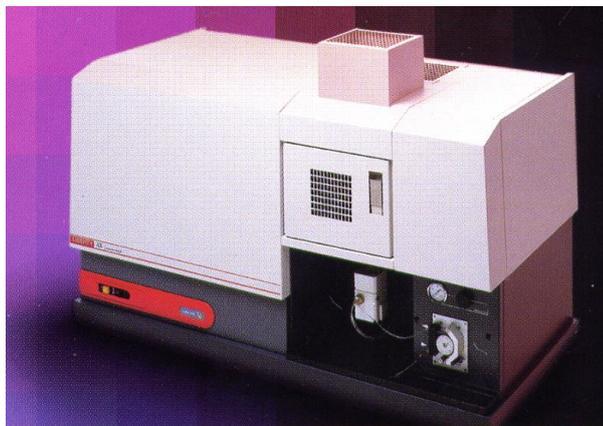
Spettrofotometro ad emissione atomica al plasma ad accoppiamento induttivo (ICP) e lettura sequenziale. Il sistema di raccolta della radiazione emessa dal plasma è di tipo assiale. Il generatore di radiofrequenze è 40 MHz. Per il raffreddamento del plasma viene impiegato argon ultrapuro.
