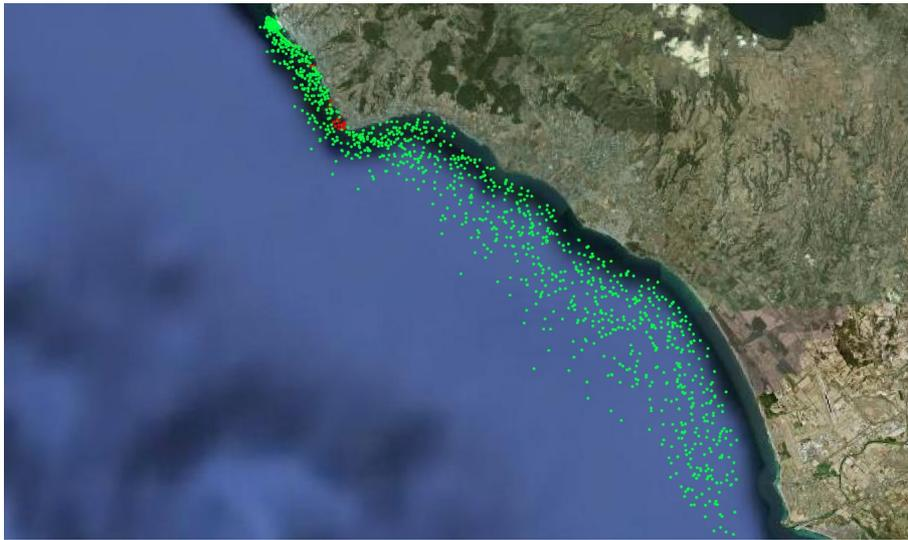
Fig. 38 : dispersione del sedimento dragato prodotto dallo scenario di Ponente (in verde il materiale in sospensione e in rosso il sedimento deposto).
