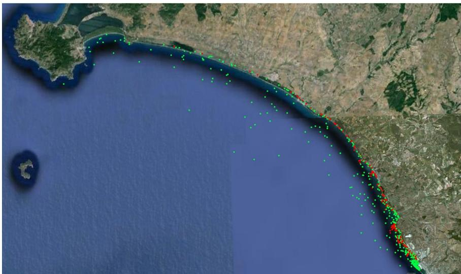
Fig. 35 : dispersione del sedimento dragato prodotto dallo scenario di Scirocco (in verde il materiale in sospensione e in rosso il sedimento deposto).
