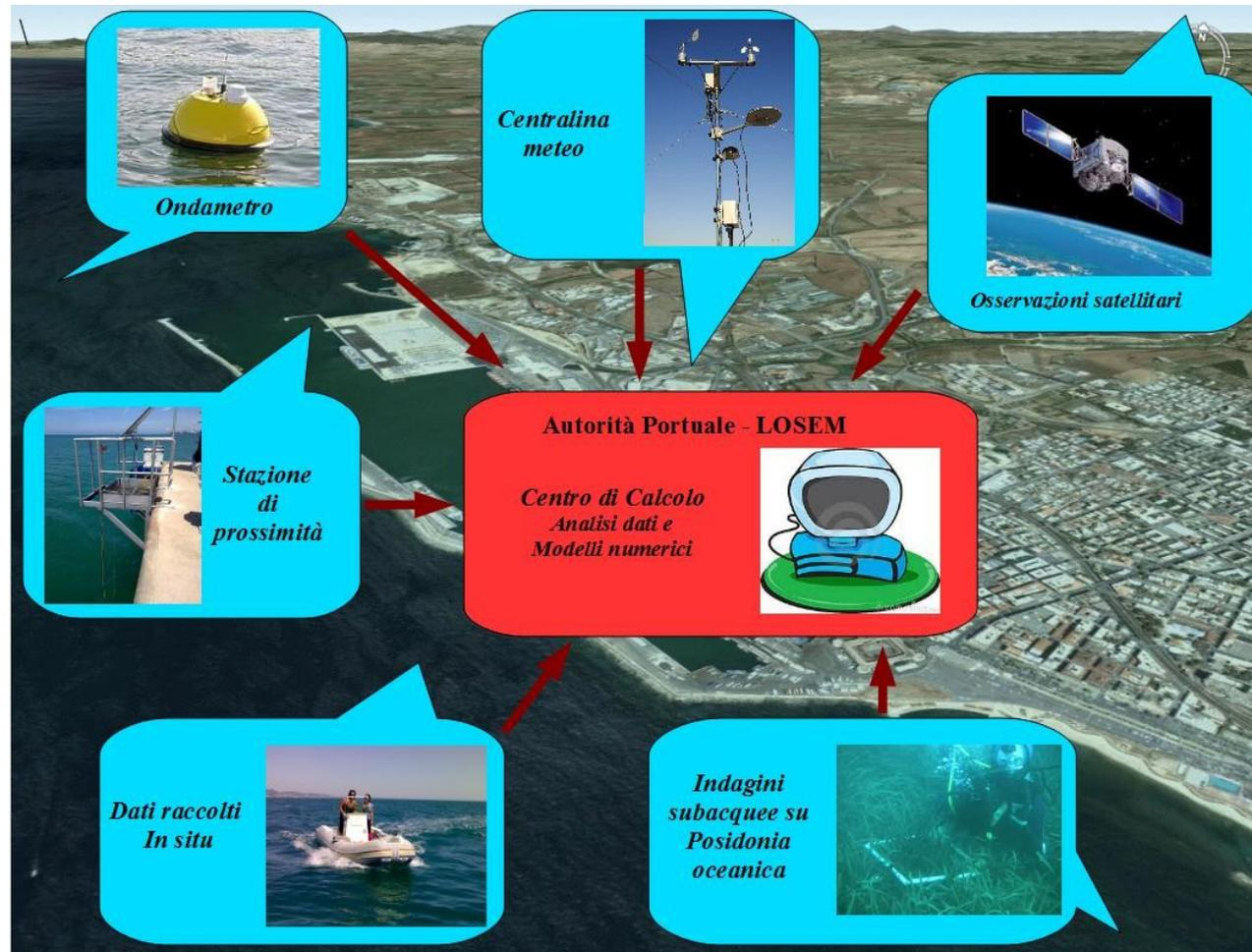
Fig.5 : schema relativo al funzionamento della Rete di Monitoraggio dell'ambiente marino costiero.
