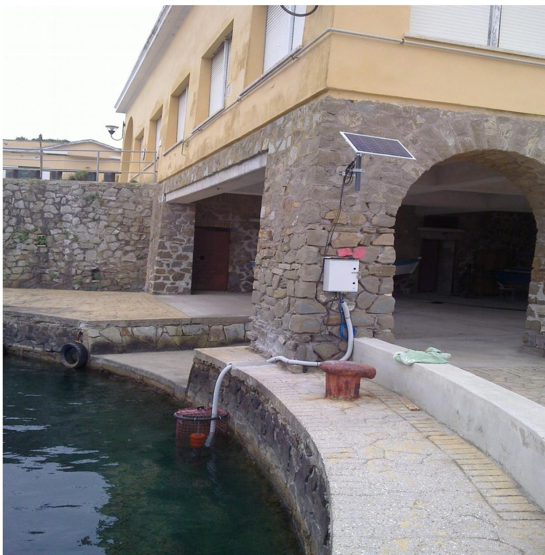
La stazione di prossimità è costituita da una serie di sensori integrati *ad hoc* per l'acquisizione in continuo dei seguenti parametri: temperatura, conducibilità, ossigeno disciolto, pH, torbidità, fluorescenza della clorofilla *a*. La nuova stazione di zero è stata installata presso il Villaggio del Fanciullo, area a sud del Porto di Civitavecchia.
