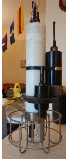
Fig. 5.3: Sonda multiparametrica utilizzata nel campionamento
