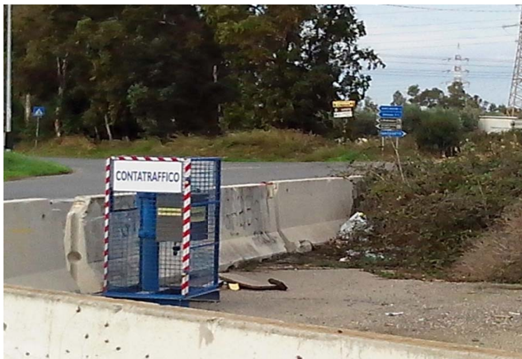
Misuratore di traffico veicolare, installazione presso S.S.Aurelia Km 76,00
