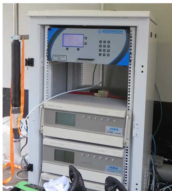
*Analizzatore di monossido di azoto NO e biossido di azoto NO<sub>2</sub> ECOTECH SERINUS 40 (NO e NO<sub>2</sub>) e Analizzatore di Monossido di Carbonio CO MONITOR EUROPE ML9830B*
