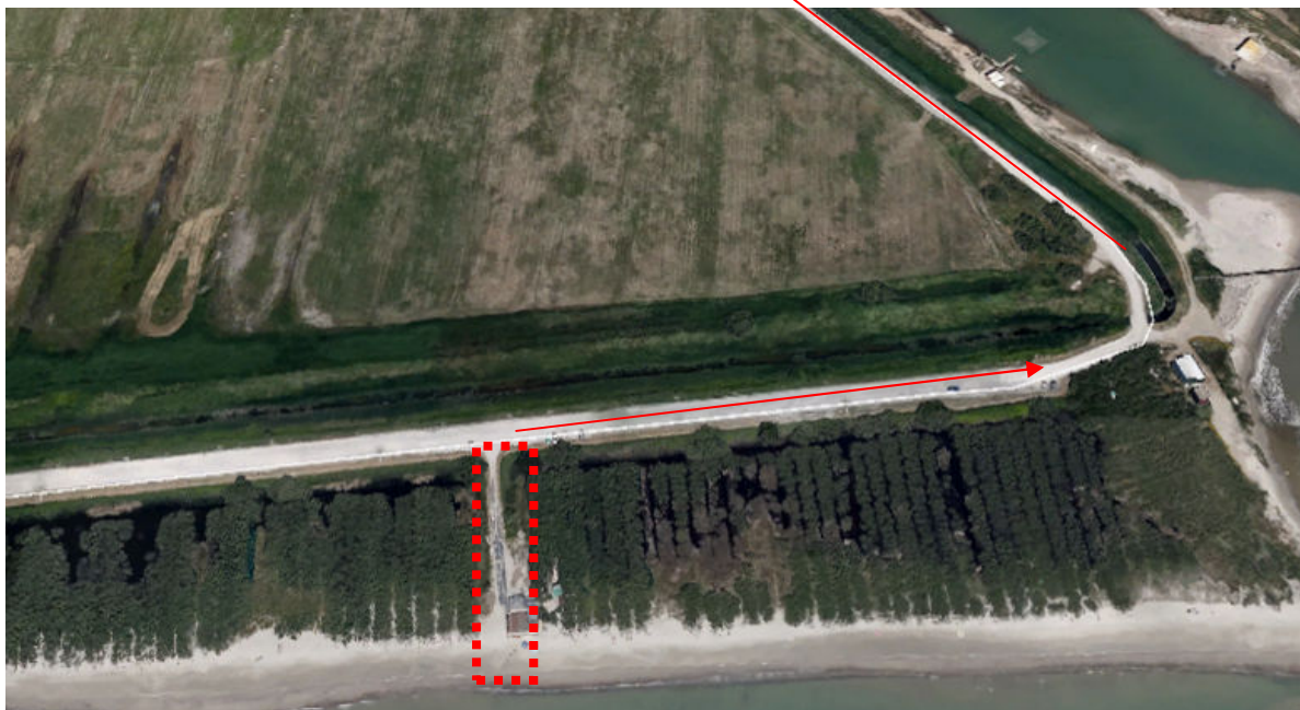
Figura 21: (Fonte: Google Earth) Punto di approdo presso Torre del Sale (il rettangolo rosso indica la collocazione del tracciato interrato lungo l'arenile, le frecce rosse indicano la direzione del cavo terrestre lungo la strada bianca)
