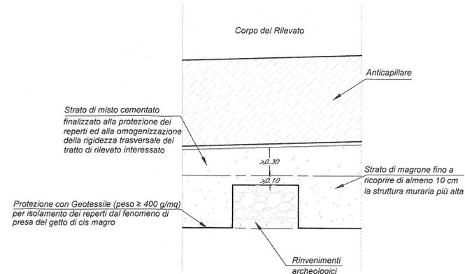
N.B. Spessore minimo di misto cementato pari a 0.30m, eventualmente riducendo lo spessore di anticipillare. Tale strato va prolungato, in direzione longitudinale, 4.00m prima e dopo i rinvenimenti al fine di omogeneizzare la rigidità longitudinale del tratto di rilevato interessato.
